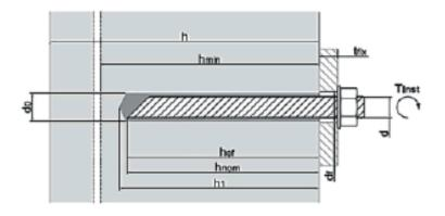
Legende: d [mm] Stangendurchmesser hmin [mm] Mindestbaudicke d0 [mm] Bohrlochdurchmesser h1 [mm] Bohrlochtlefe hnom [mm] Setztiefe hef [mm] Effektiefe Verankerungstiefe
